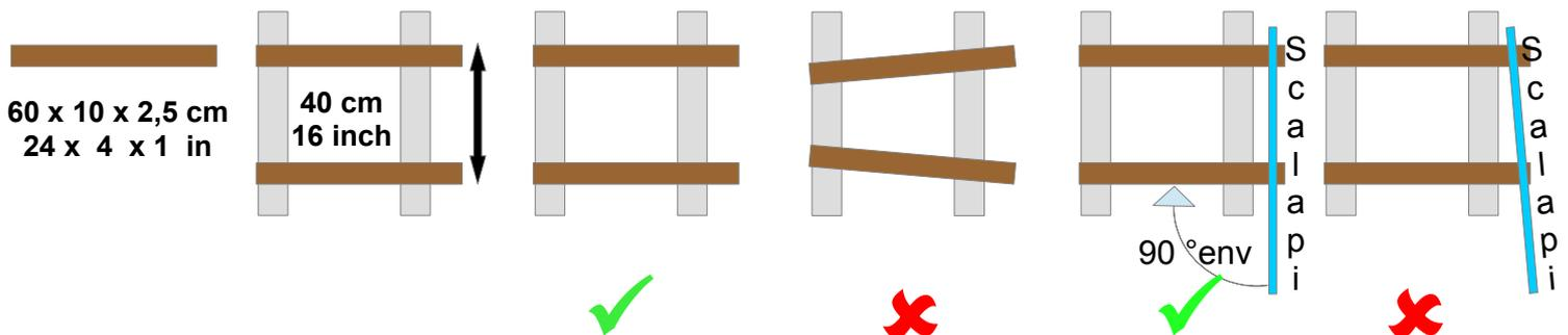
**Pesée rapide :** Elle s'effectue en emboîtant Scalapi sur les planches pivots et en le faisant basculer jusqu'au cran de blocage de la patte, il est toujours souhaitable d'effectuer une deuxième pesée et ainsi vérifier la corrélation entre les deux résultats donnés par le peson.
