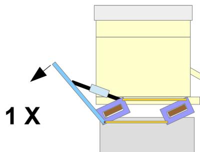
**Pesée attentive :** Opérer tout d'abord comme pour la pesée rapide, enregistrer le résultat obtenu puis retourner Scalapi sur les planches pivots et effectuer une seconde pesée. Faire la moyenne des 2 pesées relevées, les résultats obtenus avec Scalapi positionné dans un sens ou dans un autre peuvent quelquefois être différents, cela tient à la répartition de l'essaim et des provisions dans la ruche, le côté le plus lourd est l'endroit où se trouve le centre de gravité de la ruche.
