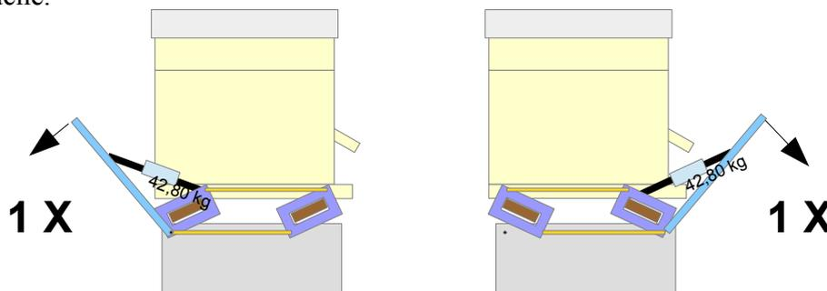
Vérifier périodiquement la justesse de votre Scalapi® à l'aide d'une masse étalon posée sur 2 planches pivot, faire correspondre le résultat donné par le peson avec le poids de la masse étalon en vissant ou dévissant l'écrou de la patte d'accroche du peson. L'état des piles et la température peuvent influencer sur la justesse.
