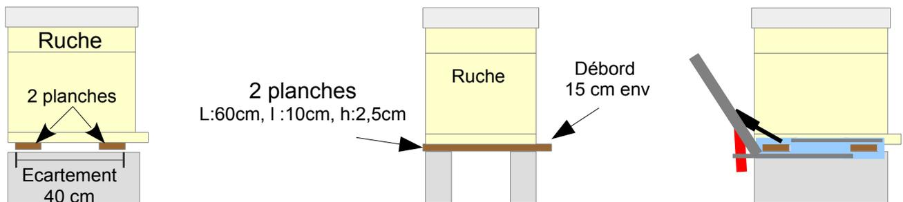
Pour une pesée de précision avec Scalapi quelques mesures à respecter, 1° avoir les planches pivots sous la ruche les plus parallèles possible 2° emboîter Scalapi perpendiculairement à ces 2 planches.
